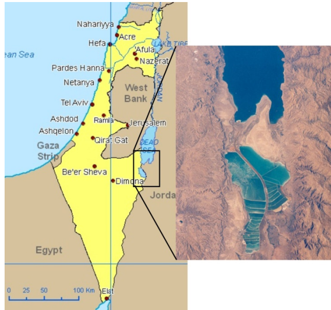
Abb. 1 Eindampfen von Wasser aus dem Toten Meer in riesigen Verdunstungsbecken zur Gewinnung verschiedener Salze (1-2 Mio. Tonnen pro Jahr)
